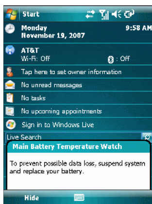
Рис. 2-7 Диалоговое окно Main Battery Temperature Watch (Наблюдение за температурой основной батареи)
