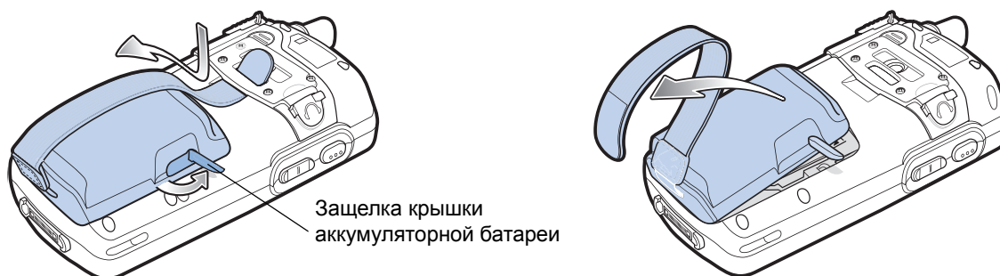
Рис. 1-11 Снятие крышки аккумуляторной батареи
