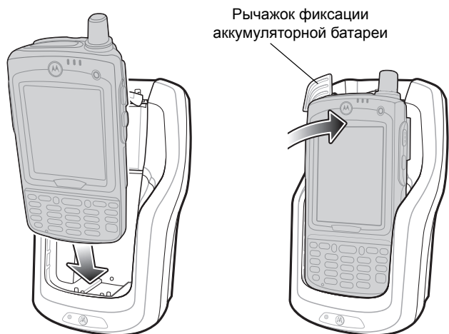
Рис. 6-5 Зарядка аккумуляторной батареи MC75
