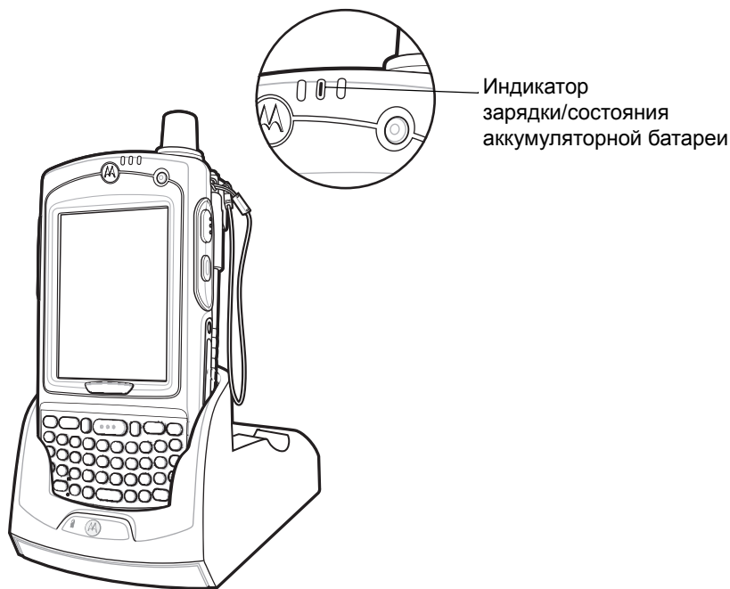
Рис. 6-1 Зарядка аккумуляторной батареи MC75
